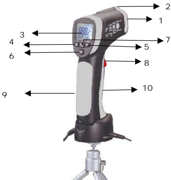
Drücken Sie, wenn beide Werte stabil sind, zur Bestätigung den UP- oder DOWN-Knopf. Das Emissionsvermögen des Objekts erscheint dann im oberen Bereich der LC-Anzeige. Drücken Sie die MODE-Taste oder triggern Sie, um in den normalen Modus zu wechseln.
